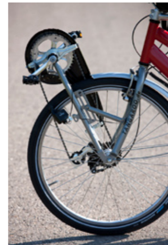
Der Nachwuchs kurbelt am Vorderrad: Gabel mit umfunktioniertem Hinterbau.
