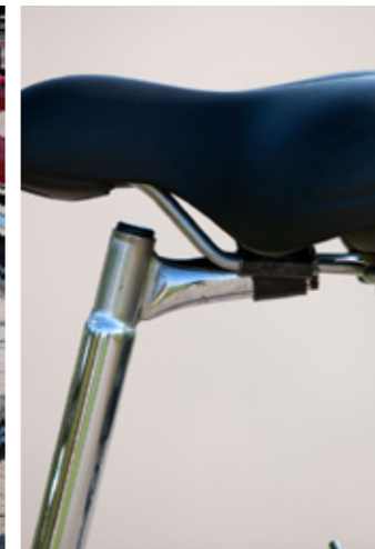
Die Extra-Halterung am Sattelrohr verbessert die Sitzposition der Eltern.
